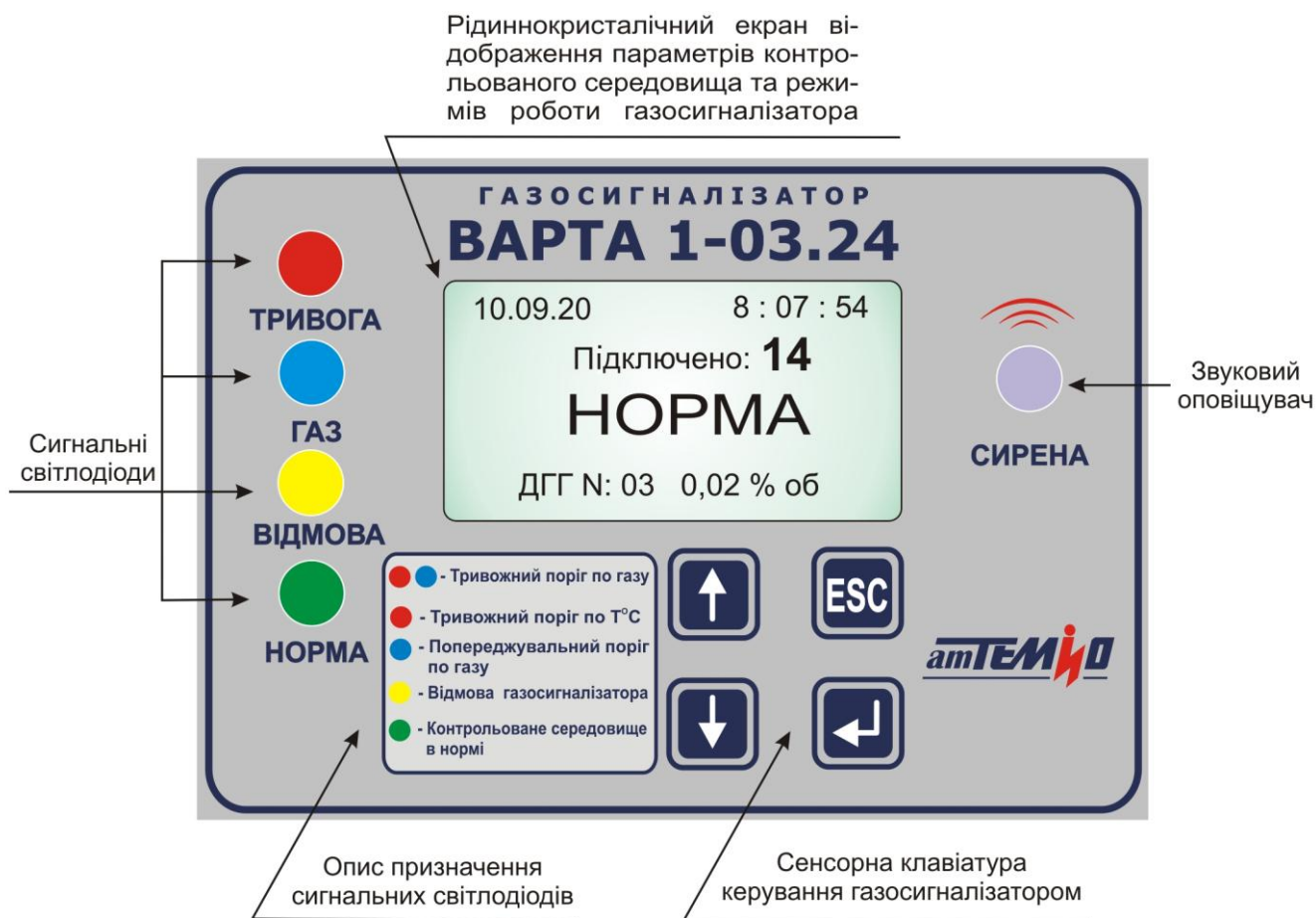
Рисунок 1 - Передня панель блока управління газосигналізатора
